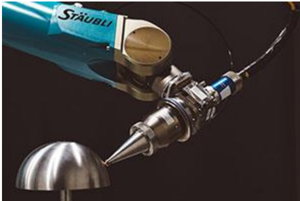
Livraison de faisceau et mise en forme basées sur une fibre à cœur creux – 100W/100fs @1030/1064nm
