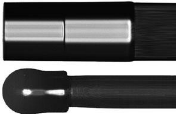
Lentilles à gradient d'indice et boule en extrémité des fibres
